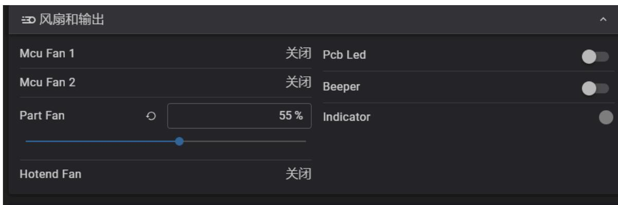
如下图设置挤出头温度为50, 看挤出头的散热风扇是否打开
