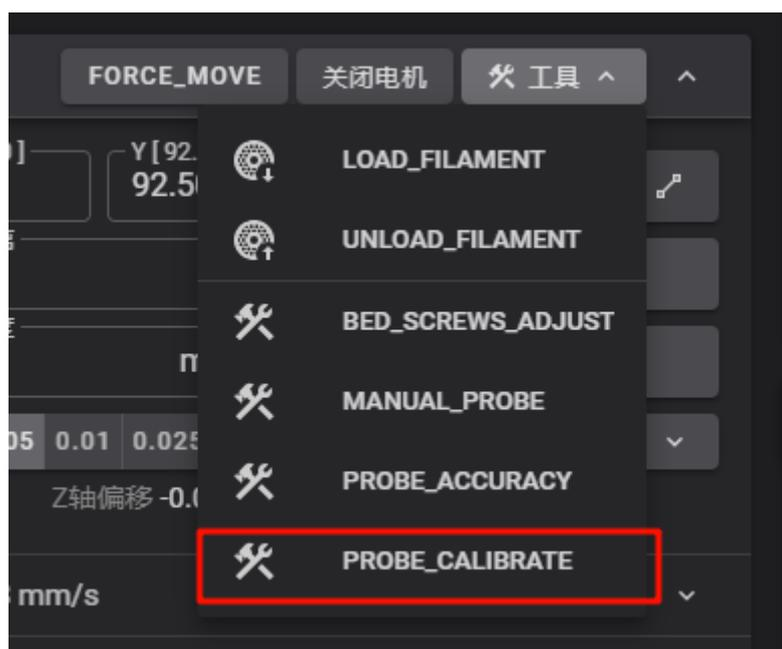
根据需要点 +/-，让挤出头比较靠近床后，点接受，再控制台中点 SAVE\_CONFIG 即可
